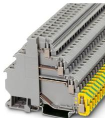
Morsetto iniziatore/attuatore, tensione nominale: 400 V, corrente nominale: 24 A, tipo di connessione: Connessione a vite, Piano 2, 3, e 4, Sezione di dimensionamento: 2,5 mm<sup>2</sup>, sezione: 0,2 mm<sup>2</sup> - 4 mm<sup>2</sup>, tipo di montaggio: NS 35/7,5, NS 35/15, colore: grigio
