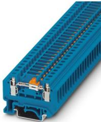
Morsetto sezionatore per conv. misura, con blocchetto scorrevole, tensione nominale: 400 V, corrente nominale: 26 A, tipo di connessione: Connessione a vite, 1. piano, Sezione di dimensionamento: 4 mm<sup>2</sup>, sezione: 0,2 mm<sup>2</sup> - 4 mm<sup>2</sup>, tipo di montaggio: NS 35/7,5, NS 35/15, NS 32, colore: blu
