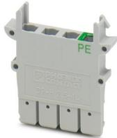
Custodia connettore, tipo di connessione: Connessione a crimpare, profondità: 31,7 mm, larghezza: 5,2 mm, altezza: 31,6 mm, numero poli: 4, colore: grigio
