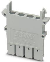
Custodia connettore, con morsetto terminale, tipo di connessione: Connessione a crimpare, profondità: 31,7 mm, larghezza: 5,2 mm, altezza: 31,6 mm, numero poli: 4, colore: grigio
