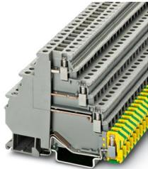
Morsetto per la connessione motore, tensione nominale: 400 V, corrente nominale: 19 A, tipo di connessione: Connessione a vite, Sezione di dimensionamento: 2,5 mm<sup>2</sup>, sezione: 0,2 mm<sup>2</sup> - 4 mm<sup>2</sup>, tipo di montaggio: NS 35/7,5, NS 35/15, colore: grigio
