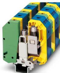
Morsetto per conduttore di terra per installazione, Viti ad esagono cavo, Blocco PE/N, costituito da un morsetto di terra verde-giallo e da un morsetto blu con ponticello a vite, tensione nominale: 1000 V, corrente nominale: 232 A, Connessione a vite, Sezione di dimensionamento: 95 mm<sup>2</sup>, sezione: 25 mm<sup>2</sup> - 95 mm<sup>2</sup>, tipo di montaggio: NS 35/7,5, NS 35/15, NS 32, colore: giallo-verde
