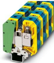
Morsetto per conduttore di terra per installazione, Blocco PE/N, costituito da un morsetto di terra verde-giallo e da un morsetto blu con ponticello a vite, tensione nominale: 1000 V, corrente nominale: 150 A, Connessione a vite, Sezione di dimensionamento: 50 mm<sup>2</sup>, sezione: 16 mm<sup>2</sup> - 50 mm<sup>2</sup>, tipo di montaggio: NS 35/7,5, NS 35/15, NS 32, colore: giallo-verde
