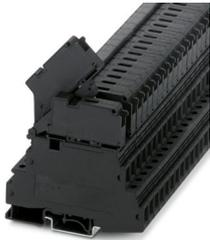
Morsetto portafusibili, tipo di fusibile: Vetro / ceramica / ..., tipo fusibile: G / 6,3 x 32, tensione nominale: 400 V, corrente nominale: 32 A, tipo di connessione: Connessione a vite, Sezione di dimensionamento: 4 mm<sup>2</sup>, sezione: 0,2 mm<sup>2</sup>- 4 mm<sup>2</sup>, tipo di connessione: Connessione a vite, sezione: 0,2 mm<sup>2</sup>- 4 mm<sup>2</sup>, tipo di montaggio: NS 35/7,5, NS 35/15, NS 32, colore: nero
