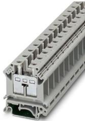
Morsetto per installazioni, tensione nominale: 400 V, corrente nominale: 76 A, Connessione a vite, Sezione di dimensionamento: 16 mm<sup>2</sup>, sezione: 2,5 mm<sup>2</sup> - 25 mm<sup>2</sup>, tipo di montaggio: NS 35/7,5, NS 35/15, NS 32, colore: grigio
