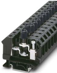
Morsetto portafusibili, tipo di fusibile: Vetro / ceramica / ..., tipo fusibile: G / 5 x 25, tensione nominale: 500 V, corrente nominale: 10 A, tipo di connessione: Connessione a vite, Sezione di dimensionamento: 1,5 mm<sup>2</sup>, sezione: 0,5 mm<sup>2</sup>- 16 mm<sup>2</sup>, tipo di montaggio: NS 35/7,5, NS 35/15, NS 32, colore: nero
