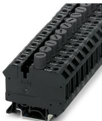
Morsetto portafusibili, tipo di fusibile: Vetro / ceramica / ..., tipo fusibile: G / 6,3 x 32, tensione nominale: 400 V, corrente nominale: 10 A, tipo di connessione: Connessione a vite, sezione: 0,5 mm<sup>2</sup>- 16 mm<sup>2</sup>, tipo di montaggio: NS 35/7,5, NS 35/15, NS 32, colore: nero
