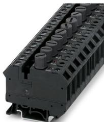
Morsetto portafusibili, tipo di fusibile: Vetro / ceramica / ..., tipo fusibile: G / 5 x 20, tensione nominale: 500 V, corrente nominale: 10 A, numero poli: 1, tipo di connessione: Connessione a vite, Sezione di dimensionamento: 1,5 mm<sup>2</sup>, sezione: 0,5 mm<sup>2</sup>- 16 mm<sup>2</sup>, tipo di montaggio: NS 35/7,5, NS 35/15, NS 32, colore: nero
