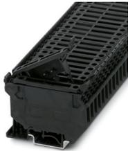
Morsetto portafusibili, tipo di fusibile: Vetro / ceramica / ..., tipo fusibile: G / 5 x 20, tensione nominale: 800 V, corrente nominale: 6,3 A, tipo di connessione: Connessione a vite, Sezione di dimensionamento: 1 mm<sup>2</sup>, sezione: 0,2 mm<sup>2</sup>- 4 mm<sup>2</sup>, tipo di montaggio: NS 35/7,5, NS 35/15, NS 32, colore: nero
