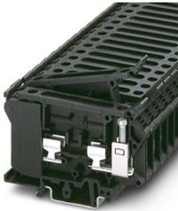
Morsetto portafusibili, tipo di fusibile: Vetro / ceramica / ..., tipo fusibile: G / 6,3 x 32, tensione nominale: 500 V, corrente nominale: 10 A, numero poli: 1, tipo di connessione: Connessione a vite, Sezione di dimensionamento: 1,5 mm<sup>2</sup>, sezione: 0,5 mm<sup>2</sup>- 16 mm<sup>2</sup>, tipo di montaggio: NS 35/7,5, NS 35/15, NS 32, colore: nero
