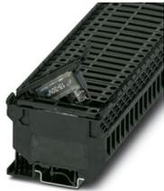
Morsetto portafusibili, tipo di fusibile: Vetro / ceramica / ..., tipo fusibile: G / 5 x 20 / 5 x 25 / 5 x 30, tensione nominale: 24 V, corrente nominale: 6,3 A, numero poli: 1, tipo di connessione: Connessione a vite, Sezione di dimensionamento: 1 mm<sup>2</sup>, sezione: 0,2 mm<sup>2</sup>- 4 mm<sup>2</sup>, tipo di montaggio: NS 35/7,5, NS 35/15, NS 32, colore: nero
