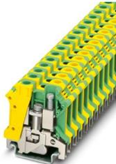
Morsetti comp. per conduttori terra, numero di connessioni: 2, tipo di connessione: Connessione a vite, Sezione di dimensionamento: 10 mm<sup>2</sup>, sezione: 0,5 mm<sup>2</sup> - 16 mm<sup>2</sup>, tipo di fissaggio: Piedino PE con vite di fissaggio M4, tipo di montaggio: NS 35/7,5, NS 35/15, NS 32, colore: giallo-verde
