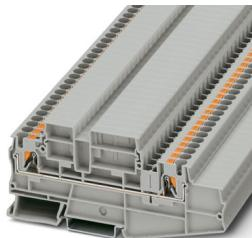
Morsetto passante, tensione nominale: 500 V, corrente nominale: 30 A, tipo di connessione: Connessione Push-in, Sezione di dimensionamento: 4 mm<sup>2</sup>, sezione: 0,2 mm<sup>2</sup> - 6 mm<sup>2</sup>, tipo di montaggio: NS 35/7,5, NS 35/15, colore: grigio
