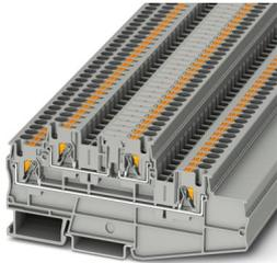
Morsetto a più piani, tensione nominale: 500 V, corrente nominale: 30 A, tipo di connessione: Connessione Push-in, 1. e 2. piano, Sezione di dimensionamento: 4 mm<sup>2</sup>, sezione: 0,2 mm<sup>2</sup> - 6 mm<sup>2</sup>, tipo di montaggio: NS 35/7,5, NS 35/15, colore: grigio
