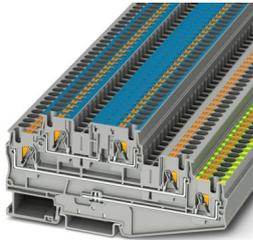
Morsetto a più piani, tensione nominale: 500 V, corrente nominale: 30 A, numero di connessioni: 5, tipo di connessione: Connessione Push-in, Sezione di dimensionamento: 4 mm<sup>2</sup>, sezione: 0,2 mm<sup>2</sup> - 6 mm<sup>2</sup>, tipo di connessione: Connessione Push-in, Sezione di dimensionamento: 4 mm<sup>2</sup>, sezione: 0,2 mm<sup>2</sup> - 6 mm<sup>2</sup>, tipo di montaggio: NS 35/7,5, NS 35/15, colore: grigio
