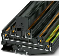
Morsetto portafusibili, tipo di fusibile: Vetro / ceramica / ..., tipo fusibile: G / 5 x 20, tensione nominale: 250 V, corrente nominale: 6,3 A, tipo di connessione: Connessione Push-in, Sezione di dimensionamento: 4 mm<sup>2</sup>, sezione: 0,2 mm<sup>2</sup>- 6 mm<sup>2</sup>, tipo di connessione: Connessione Push-in, sezione: 0,2 mm<sup>2</sup>- 6 mm<sup>2</sup>, tipo di montaggio: NS 35/7,5, NS 35/15, colore: nero
