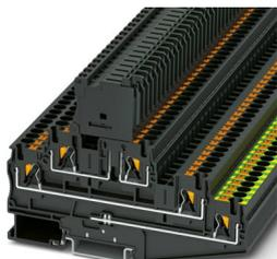
Morsetto portafusibili, tipo di fusibile: Vetro / ceramica / ..., tipo fusibile: G / 5 x 20, tensione nominale: 24 V, corrente nominale: 6,3 A, tipo di connessione: Connessione Push-in, Sezione di dimensionamento: 4 mm<sup>2</sup>, sezione: 0,2 mm<sup>2</sup>- 6 mm<sup>2</sup>, tipo di connessione: Connessione Push-in, sezione: 0,2 mm<sup>2</sup>- 6 mm<sup>2</sup>, tipo di montaggio: NS 35/7,5, NS 35/15, colore: nero
