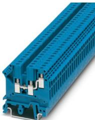
Morsetto passante, tensione nominale: 400 V, corrente nominale: 24 A, tipo di connessione: Connessione a vite, 1. piano, Sezione di dimensionamento: 2,5 mm<sup>2</sup>, sezione: 0,2 mm<sup>2</sup> - 2,5 mm<sup>2</sup>, tipo di montaggio: NS 35/7,5, NS 35/15, NS 32, colore: blu
