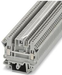
Morsetto passante, tensione nominale: 250 V, corrente nominale: 24 A, numero di connessioni: 3, numero poli: 1, tipo di connessione: Connessione a vite/a innesto, 1. piano, sezione: 0,2 mm<sup>2</sup> - 4 mm<sup>2</sup>, tipo di montaggio: NS 32, NS 35/15, NS 35/7,5, colore: grigio
