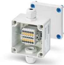
Scatola di connessione, con 6 morsetti da 2,5 mm<sup>2</sup> con connessione push-in, materiale: ABS, grigio, 85 mm x 83 mm x 60 mm, tipo di chiusura: coperchio avvitato
