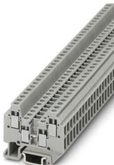
Micromorsetti, tensione nominale: 400 V, corrente nominale: 17,5 A, tipo di connessione: Connessione a vite, Sezione di dimensionamento: 1,5 mm<sup>2</sup>, sezione: 0,14 mm<sup>2</sup> - 1,5 mm<sup>2</sup>, tipo di montaggio: NS 15, colore: grigio
