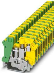
Morsetti comp. per conduttori terra, tipo di connessione: Connessione a vite, 1. piano, Sezione di dimensionamento: 10 mm<sup>2</sup>, sezione: 0,5 mm<sup>2</sup> - 16 mm<sup>2</sup>, Connessione a vite, 1. piano, collegamento a destra, Sezione di dimensionamento: 4 mm<sup>2</sup>, sezione: 0,2 mm<sup>2</sup> - 6 mm<sup>2</sup>, tipo di montaggio: NS 35/7,5, NS 35/15, NS 32, colore: giallo-verde
