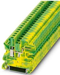
Morsetti comp. per conduttori terra, Corrente e tensione sono determinate dalla spina impiegata., numero di connessioni: 2, tipo di connessione: Connessione a vite/a innesto, sezione: 0,14 mm<sup>2</sup> - 6 mm<sup>2</sup>, tipo di montaggio: NS 35/7,5, NS 35/15, colore: giallo-verde
