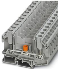
Morsetto sezionatore, con viti per prese di prova per l'alloggiamento di spine di prova, tensione nominale: 1000 V, corrente nominale: 41 A, 1. piano, tipo di connessione: Bullone, Sezione di dimensionamento: 6 mm<sup>2</sup>, montaggio: NS 35/7,5, NS 35/15, NS 32, colore: grigio
