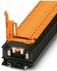
Morsetti sezionatori con leva, tensione nominale: 500 V, corrente nominale: 16 A, tipo di connessione: Connessione a vite, Sezione di dimensionamento: 1,5 mm<sup>2</sup>, sezione: 0,2 mm<sup>2</sup> - 6 mm<sup>2</sup>, montaggio: NS 35/7,5, NS 35/15, NS 32, colore: nero/arancio
