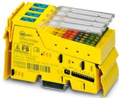
Modulo di ingresso digitale legato alla sicurezza, grado di protezione IP20 per sistema SafetyBridge, INTERBUS-Safety e PROFIsafe. Il modulo dispone di quattro ingressi digitali sicuri nel caso della struttura a due canali o di otto ingressi digitali protetti nel caso di una struttura a canale singolo.
