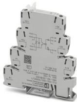
PLC-INTERFACE, relè a stato solido integrato, con connessione a vite, per il montaggio su guida di supporto NS 35/7,5, ingresso: 5 V DC, uscita: 12-300 V DC/1 A
