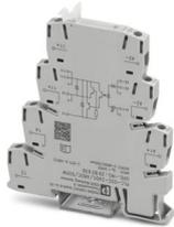
PLC-INTERFACE, con contatto di scambio elettronico, composta da morsetto base PLC-BSC.../21 con connessione a vite e relè a stato solido in miniatura integrato, per il montaggio su guida DIN NS 35/7,5, 1 contatto deviatore, ingresso: 24 V DC, uscita: 3 V DC ... 48 V DC/500 mA
