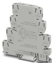
PLC-INTERFACE come relè di carico di inversione elettronico, composta da morsetto base PLC-BSC.../21 con collegamento a molla e circuito integrato, per il comando di motori DC con display luminoso e cablaggio di protezione, uscita: 10 ... 30 V DC/2 A
