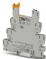
Morsetto base PLC da 6,2 mm, contro correnti e/o tensioni di disturbo sul lato di comando con connessione a vite, senza equipagg. relè o relè a stato solido, per il montaggio su guida di montaggio NS 35/7,5, con assorbimento di potenza in ingresso aumentato, 1 contatto di scambio, tens. di ingr. 24 V DC
