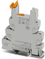
Morsetto base PLC da 14 mm contro correnti e/o tensioni di disturbo sul lato di comando con connessione a vite, senza equipaggiamento relè o relè a stato solido, per il montaggio su guida DIN NS 35/7,5, con filtro RC integrato, 2 contatti deviatori, tensione d'ingresso di 120 V AC
