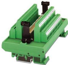
Modulo VARIOFACE, con connettore IEC 603/ DIN 41612, formato C, da 64 poli, equipaggiato a, c, con connettore maschio, per connettori a vite
