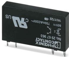
Relè a stato solido in miniatura a innesto, relè a stato solido di potenza, 1 contatto aperto a riposo, ingresso: 60 V DC, uscita: 24-253 V AC/ 0,75 A
