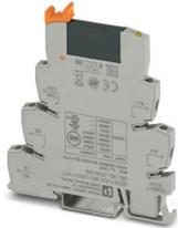
PLC-INTERFACE per funzioni di output, composta da morsetto base PLC-BSC.../ACT con connessione a vite e relè a stato solido in miniatura a innesto, per il montaggio su guida di montaggio NS 35/7,5, 1 contatto aperto a riposo, ingresso: 24 V DC, uscita: 24 ... 253 V AC/0,75 A
