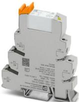
PLC-INTERFACE, composta da morsetto base PLC-BSC.../21 HC con connessione a vite e relè in miniatura a innesto per elevate correnti permanenti, per montaggio su guida di supporto NS 35/7,5, 1 contatto di scambio, tensione di ingresso 48 V DC, corrente limite permanente fino a 10 A
