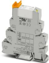
PLC-INTERFACE, composta da morsetto base PLC-BSC.../21 con connessione a vite e relè in miniatura a innesto con contatto universale dorato, per montaggio su guida di supporto NS 35/7,5, 2 contatti di scambio, tensione di ingresso 60 V DC
