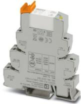
PLC-INTERFACE per funzioni di output, composto da morsetto base PLC-BSC...ACT con connessione a vite e relè in miniatura a innesto con contatto di potenza, per montaggio su guida di montaggio NS 35/7.5, 2 contatti aperto a riposo (1-1), tensione di ingresso 24 V DC
