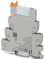
PLC-INTERFACE, composta da morsetto base PLC-BSC.../21 con connessione a vite e relè in miniatura a innesto con contatto universale dorato, per montaggio su guida di supporto NS 35/7,5, 1 contatto di scambio, tensione di ingresso 12 V DC
