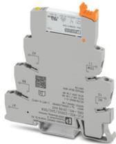
PLC-INTERFACE per funzioni di input, composta da morsetto base PLC-BSC.../SEN con connessione a vite e relè in miniatura a innesto con contatto in oro multistrato, per il montaggio su guida di montaggio NS 35/7,5, 1 contatto chiuso a riposo, tens. di ingresso 230 V AC/220 V DC
