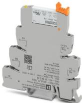
PLC-INTERFACE per funzioni di input, composta da morsetto base PLC-BSC.../SEN con connessione a vite e relè in miniatura a innesto con contatto di potenza, per il montaggio su guida di montaggio NS 35/7,5, 1 contatto aperto a riposo, tens. di ingresso 120 V AC/110 DC
