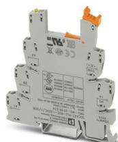
Morsetto base PLC da 6,2 mm per funzioni di input con connessione a vite, senza equipagg. relè o relè a stato solido, per il montaggio su guida di montaggio NS 35/7,5, con sensore di ripartizione della tensione di alimentazione (BB) 1 contatto aperto a riposo, tens. di ingr. 120 V AC/DC
