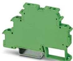
Modulo invertito. Il modulo è preposto alla conversione dei segnali d'uscite transistor NPN in uscite PNP con interruzione del segnale positivo, così come segnali con interruzione PNP in segnali con commutazione NPN con interruzione del segnale negativo (vedere esempio applicativo).
