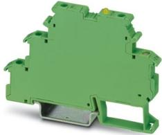
Morsetto a relè a stato solido di potenza per attuatore, ingresso: 24 V DC, uscita: 3-30 V DC/3 A, spessore morsetti 6,2 mm
