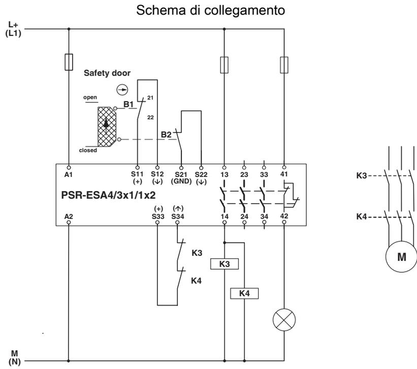
Controllo finecorsa ripari a due canali
