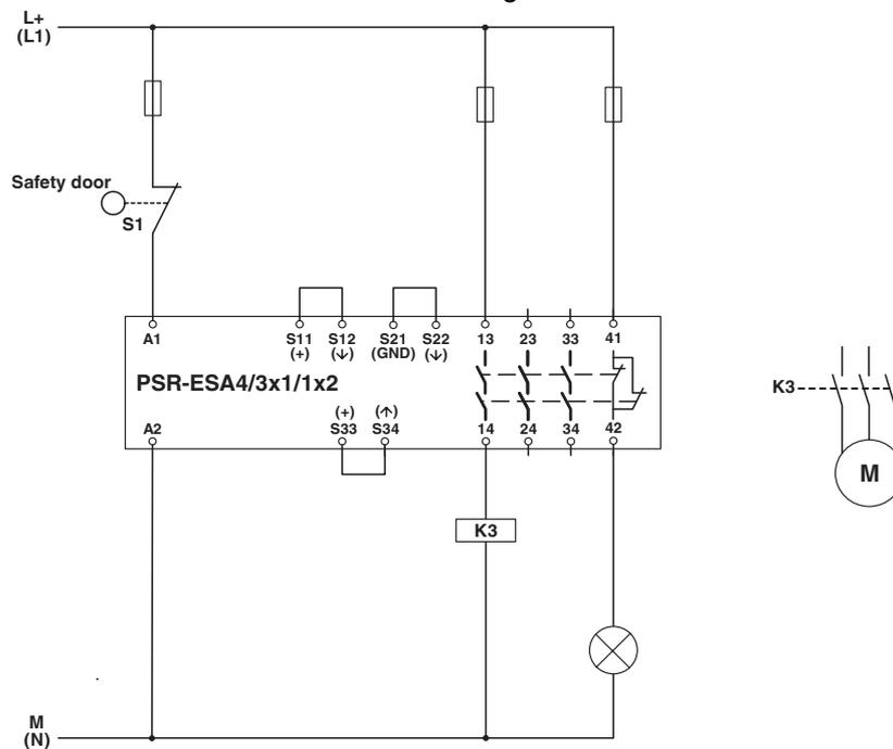
Controllo finecorsa ripari a un canale
