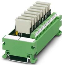
Modulo di uscita VARIOFACE COMPACT LINE con 8 relè a innesto in miniatura, a 1 contatto in chiusura, 24 V DC (incl. relè)
