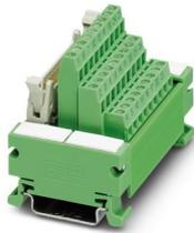
Modulo VARIOFACE con connessione a vite e connettore per cavo piatto, per montaggio su NS 35/7.5, n. poli 26
